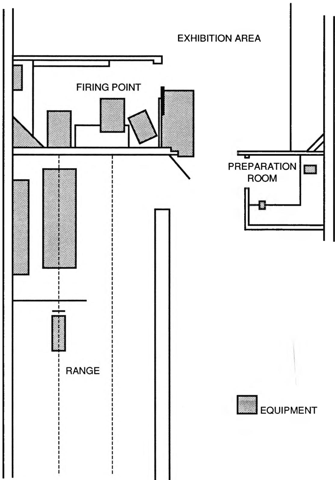
FIG. 18 PLAN OF BALLISTIC TEST FACILITY.
