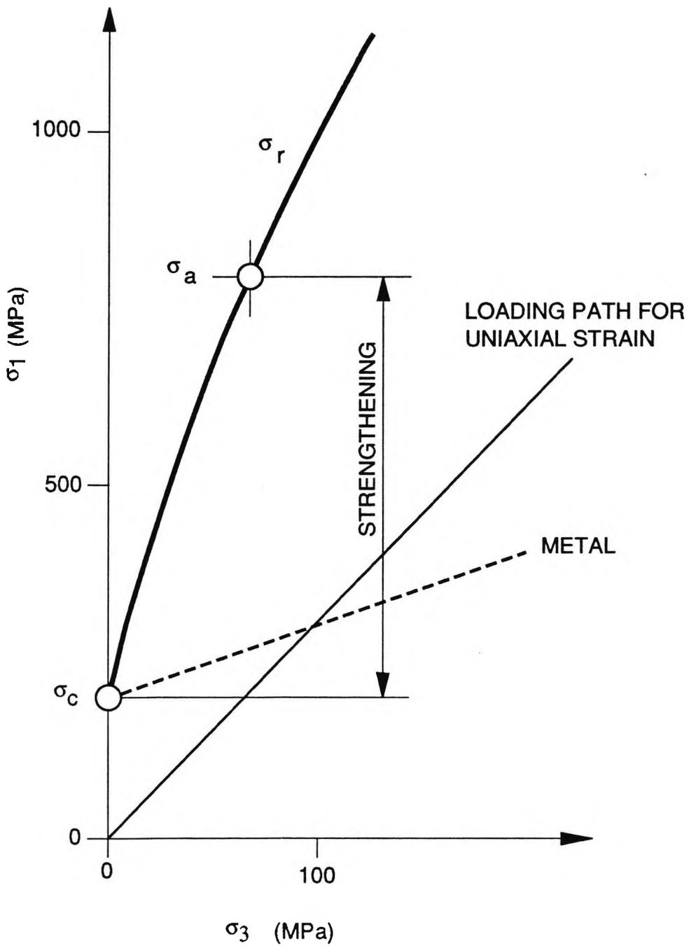
**FIG.12. FAILURE ENVELOPE FOR GRANITE UNDER TRIAXIAL COMPRESSION (AFTER JANACH).**
