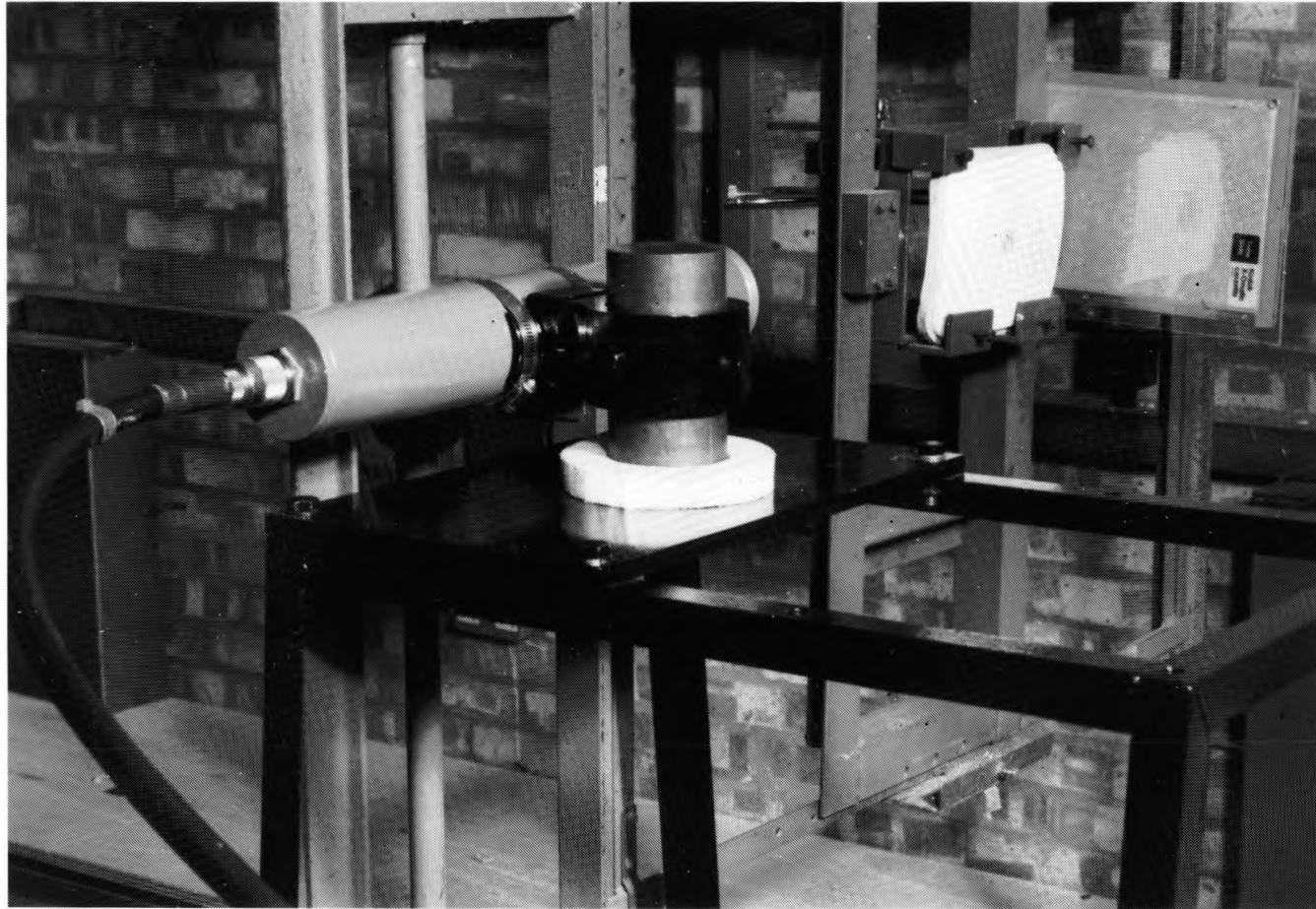
FIG. 27. SET UP FOR FLASH RADIOGRAPHY.
