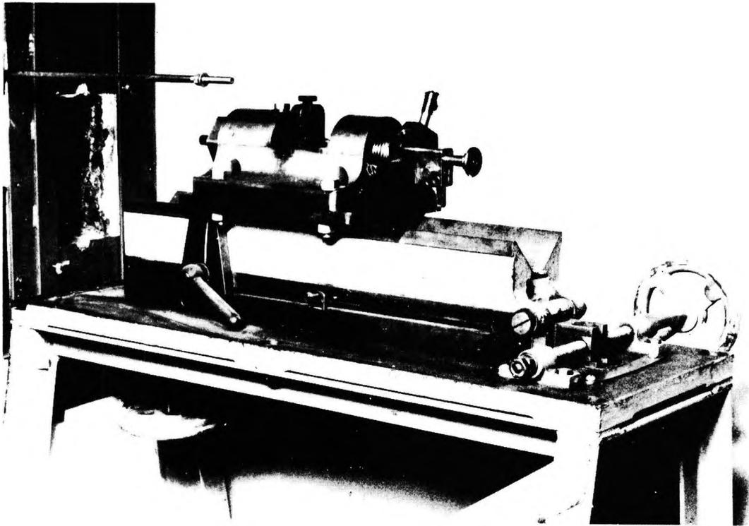
**FIG. 21. PRESSURE HOUSING FOR BALLISTIC TESTING.**
