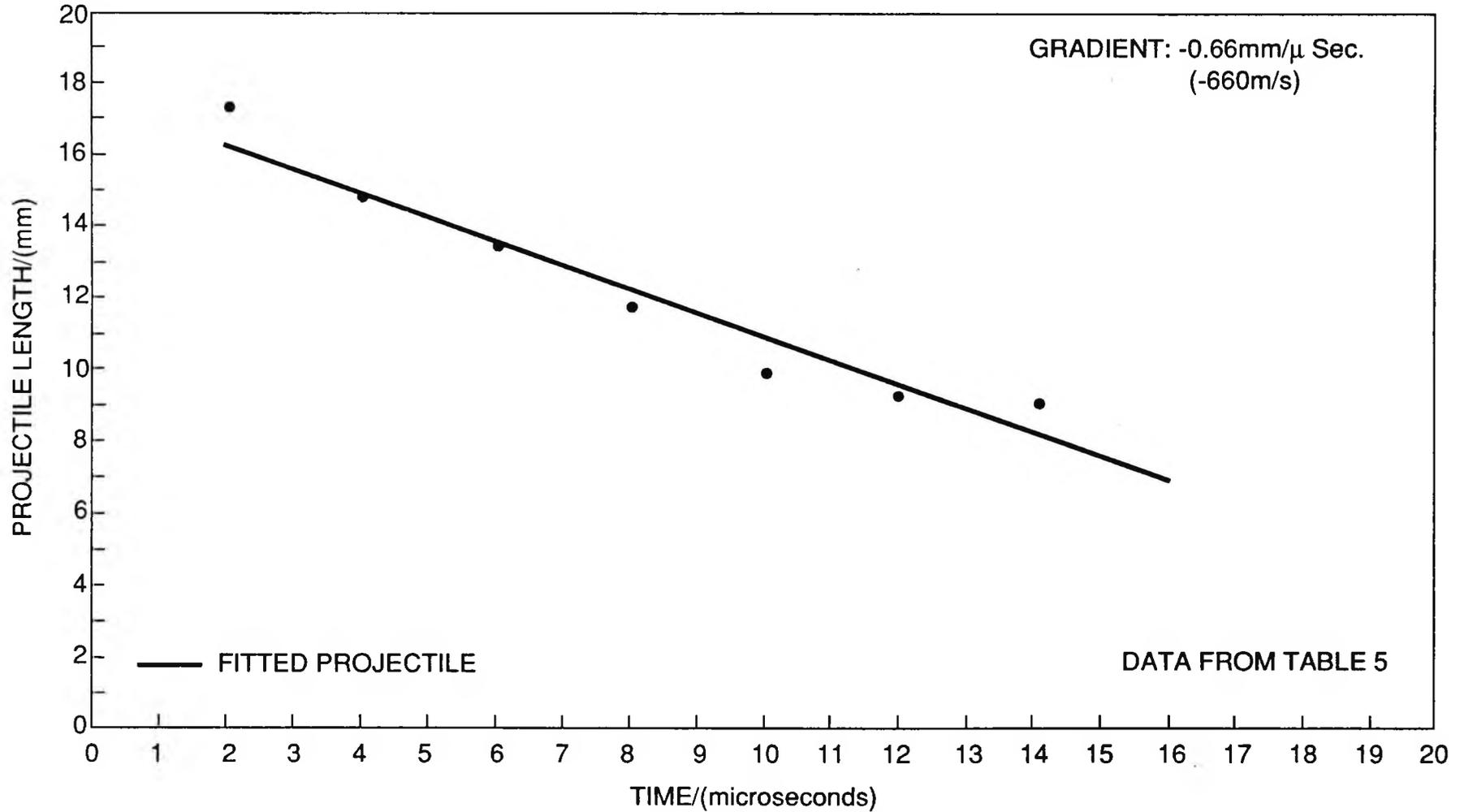
**FIG. 35. EROSION OF THE BULLET AS IT PENETRATES
