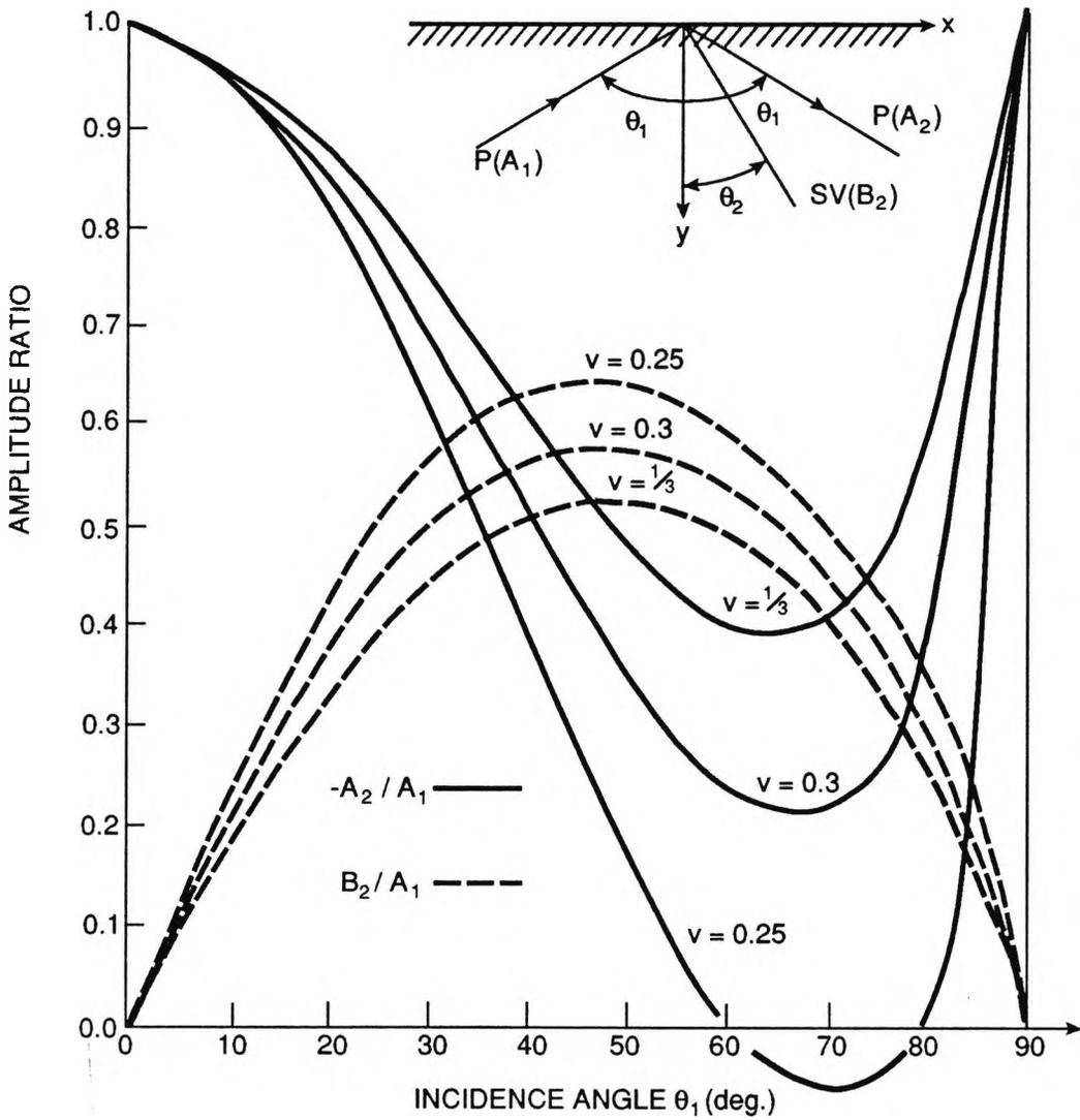
AMPLITUDE RATIOS  $A_2 / A_1$ ,  $B_2 / A_1$  FOR INCIDENT P WAVES, FOR VARIOUS POISSON'S RATIOS, WITH A RAY REPRESENTATION OF THE REFLECTION ALSO SHOWN. (AFTER KOLSKY).
