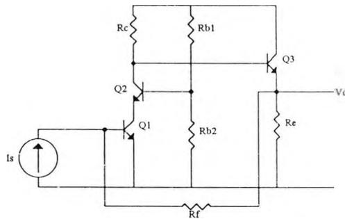
FIG. 4.34 Cascode Configuration (CE-CB)
