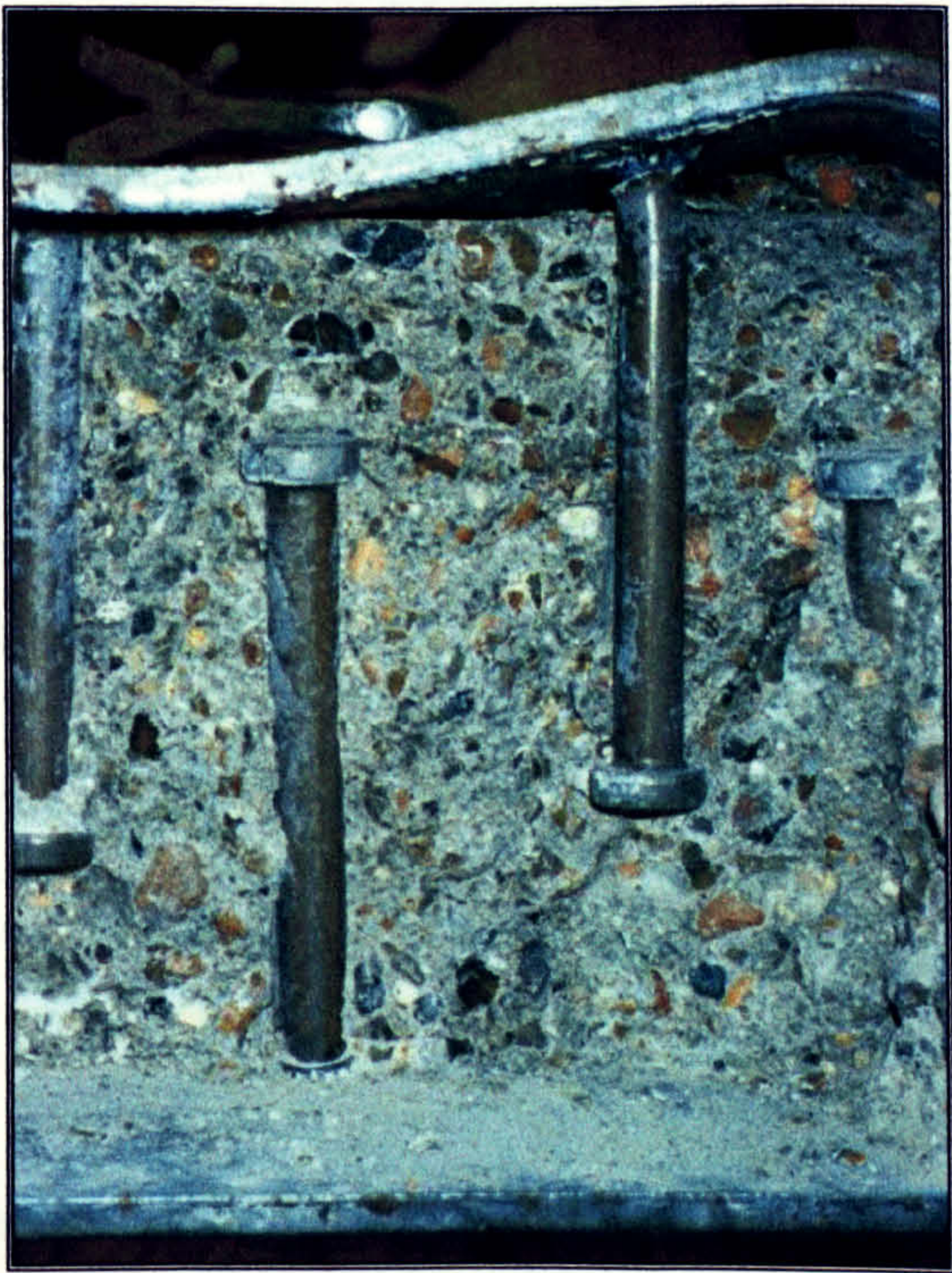
Plate 4.2. Stud pullout of Stud2b
